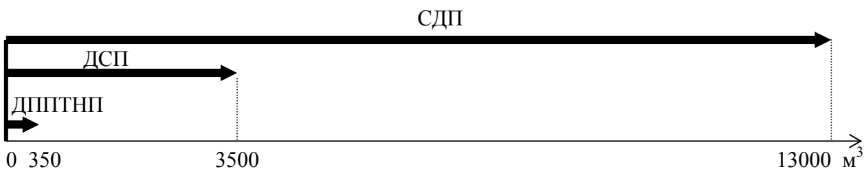
Рис.2. Сравнение удельных объемов пылегазовых выбросов из печных труб дуговых печей
