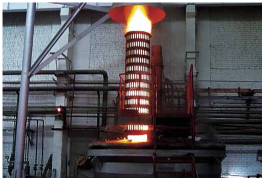
РИС. 10. Плавка металлов в ДППТУ-НП с организованным дожиганием отходящих газов при плавке сильно загрязненной шихты (см. на рис. 9).
