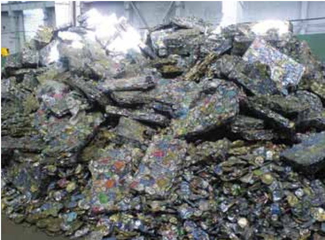
РИС. 6. Пример шихты (алюминиевая банка).
